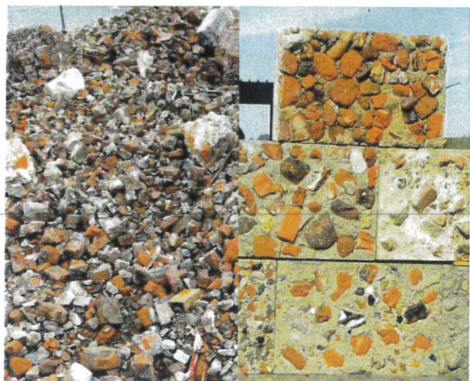
Réutilisation de gravats de démolition pour la fabrication de blocs béton
